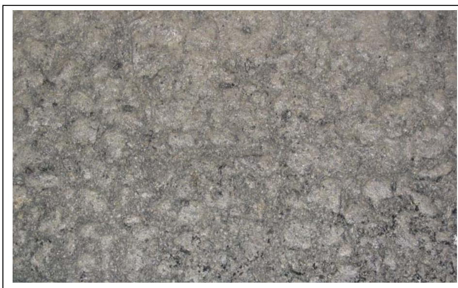
Abbildung 6-25: Oberfläche des WDA im Versuchsfeld 3 nach 30.000 Überrollungen
