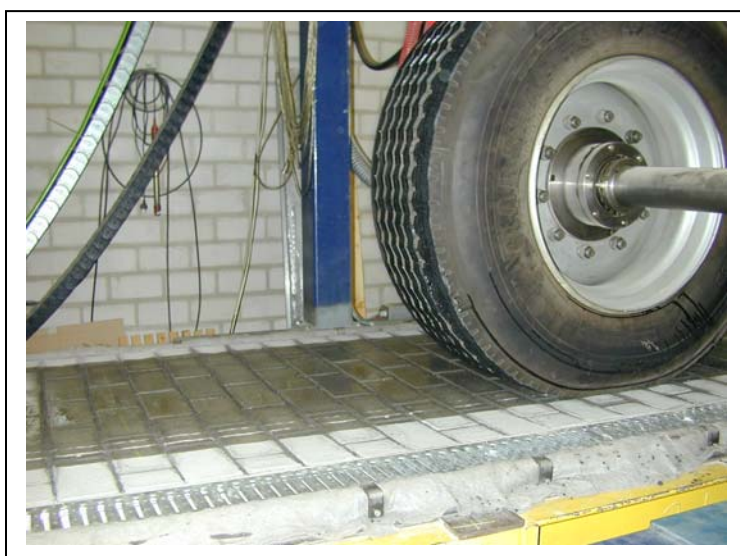
Abbildung 5-12: Regensimulation während des Fahrbetriebs
