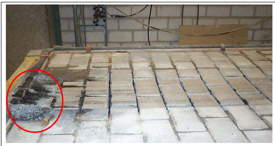
Abbildung 6-20: Herausgedrücktes Bettungsmaterial im Versuchsfeld 2
