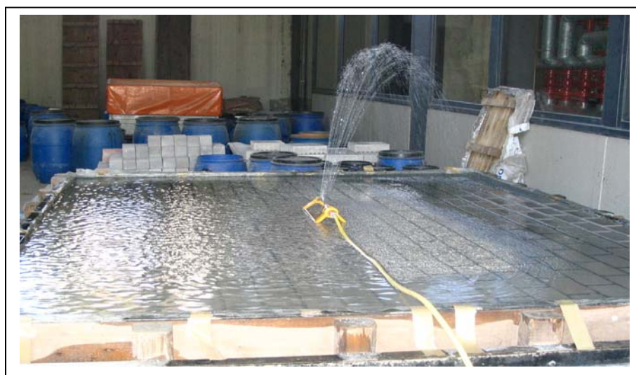
Abbildung 6-14: Fehlende Versickerungsfähigkeit im Versuchsfeld 2 mit „ATS“
