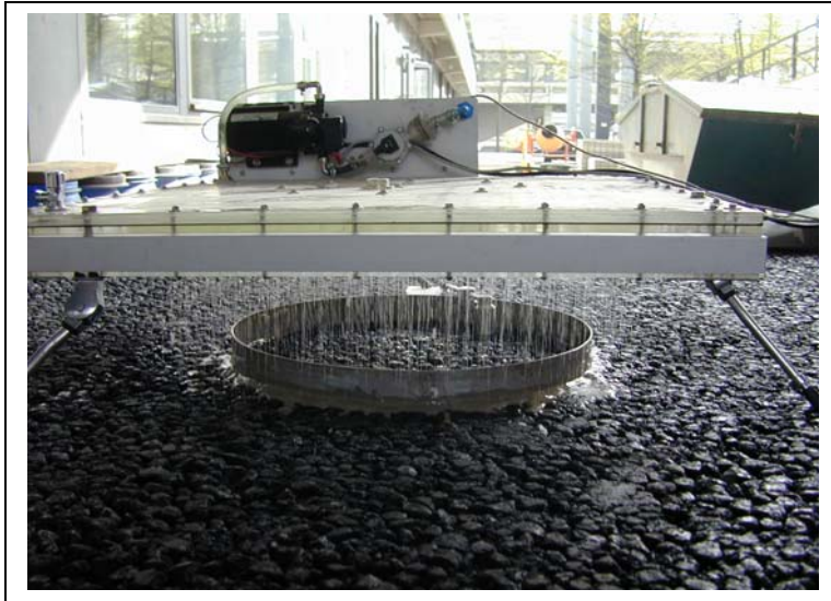
Abbildung 5-7: Messung der Infiltrationsrate auf dem WDA im Versuchsfeld 1 des Feldversuchsstandes
