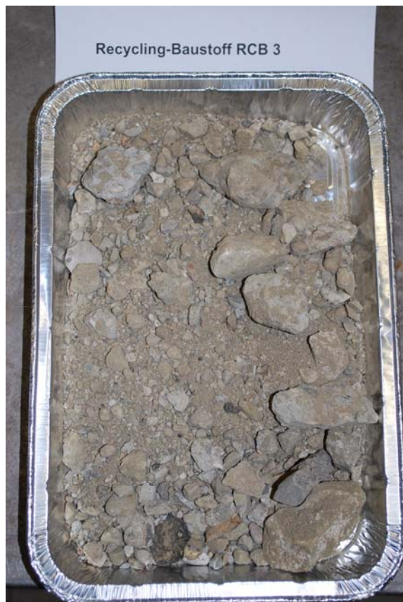
Bild 1: aufbereitete Probe RCB 3, Korngemisch 0/45 mm
