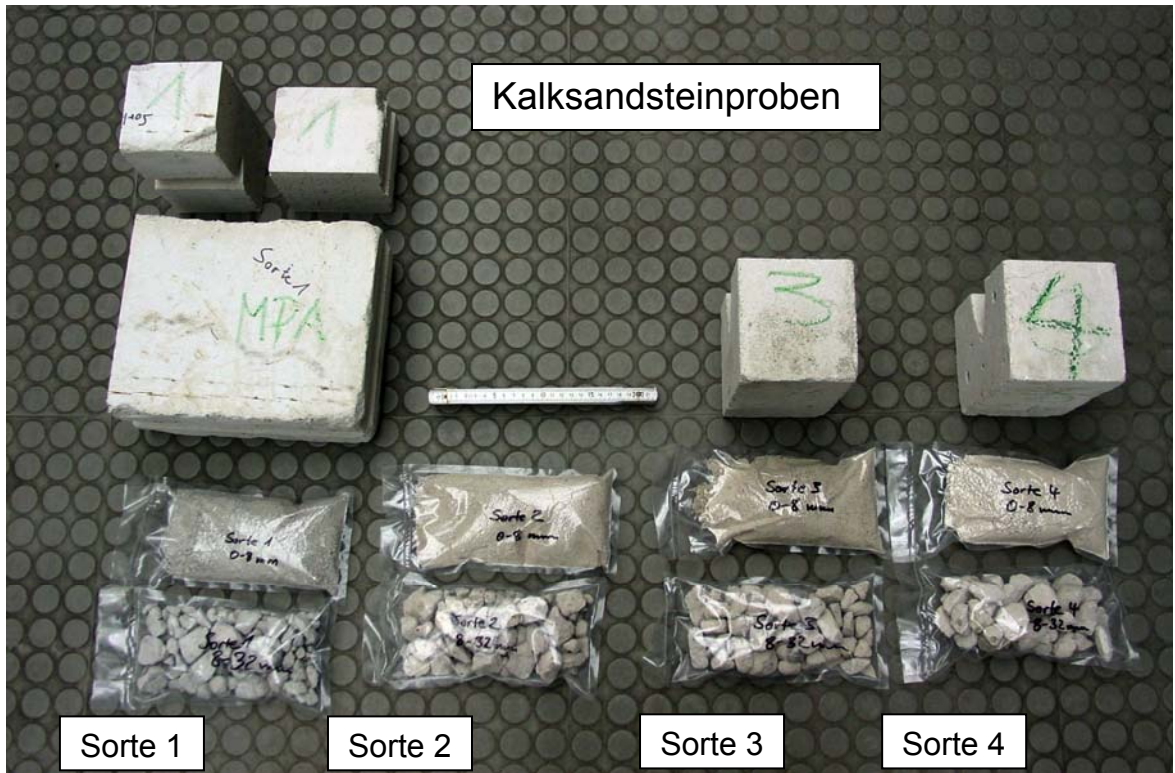
Bild 5: Proben im Anlieferungszustand - Kalksandsteinproben
