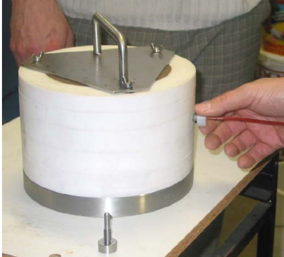
Bild 21: Prüfzylinder aus Teflon mit Edelstahlgrundplatte und Temperaturfühler [21]
