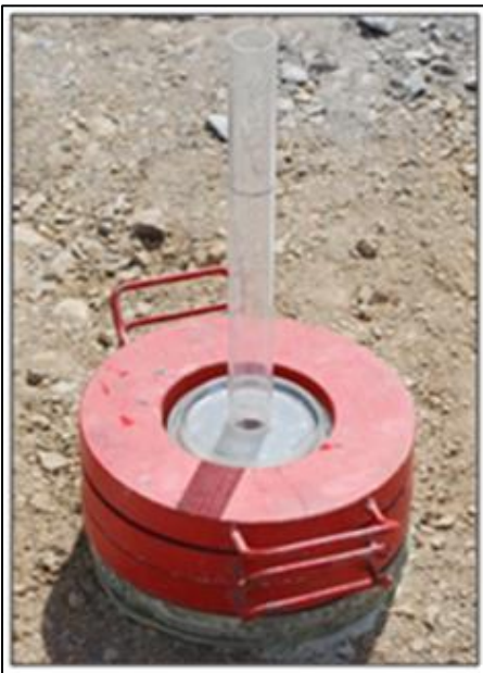
Bild 4-5: einfaches Standrohr-Infiltrometer (in situ)
