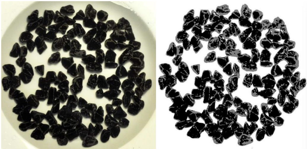
Bild 6-32: Original-Bild rechts, „Cluster-Bild“ links - Grauwacke nach 24 h mit 6.R1 30/45 [Böhler, 2014]
